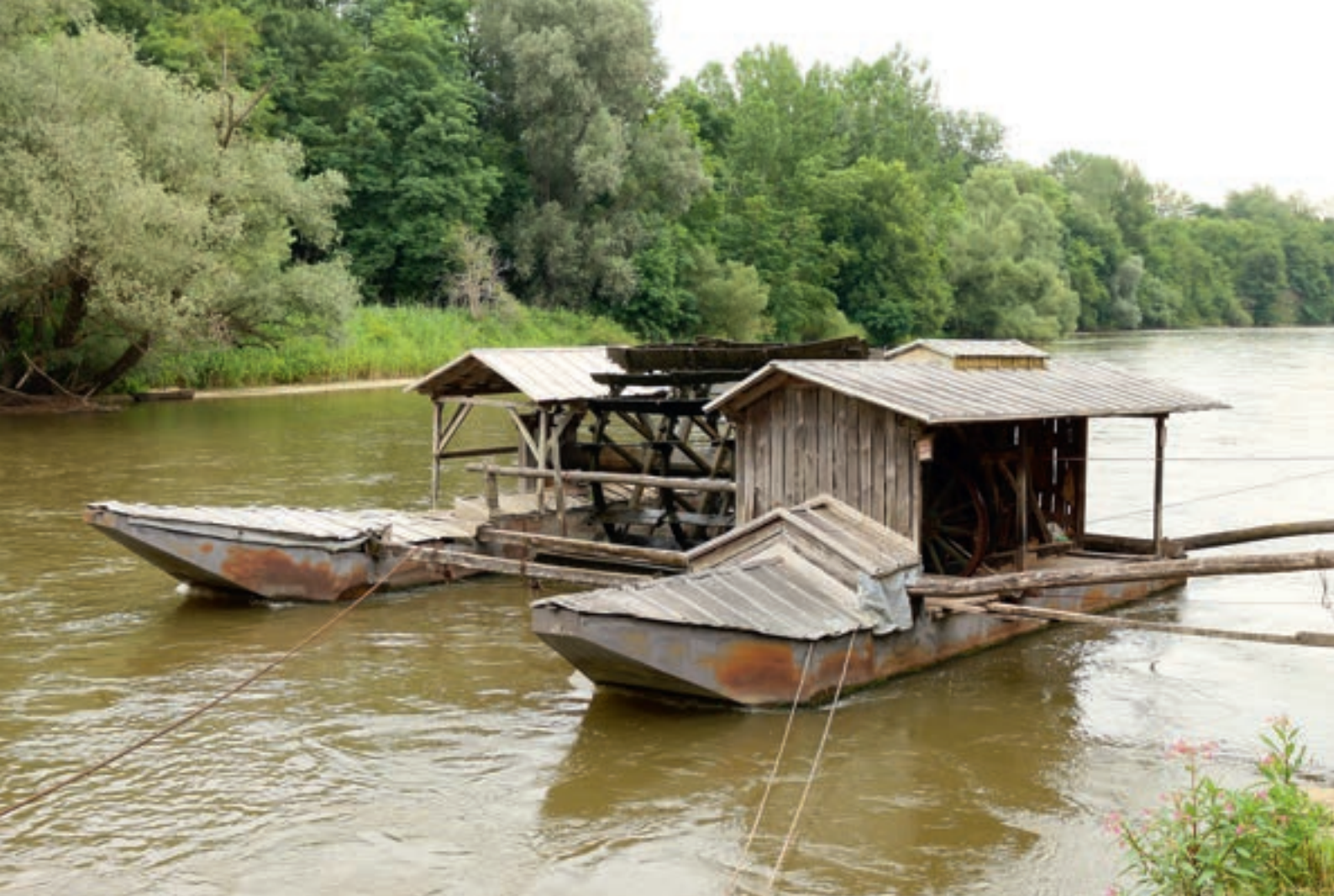
Acht eeuwen geschiedenis overbrugd. Dit is een nog bestaande en werkende schipmolen op de rivier de Mur of Mura in Slovenië (zie International Molinology , nummer 96, p. 46). De schipmolen te Meinerswijk heeft er waarschijnlijk ook zo uitgezien. Op de afgebeelde molen bevinden de maalwerktuigen zich alleen niet op de voorste boot maar in een gebouw op de oever. De aandrijving daarvan geschiedt door een staalkabel vanaf de boot. Ook is het waarschijnlijk dat de boot aan de rivierzijde in Meinerswijk niet overkapt is geweest zoals hier, maar open (foto Willem van Bergen, 14 juli 2017).
