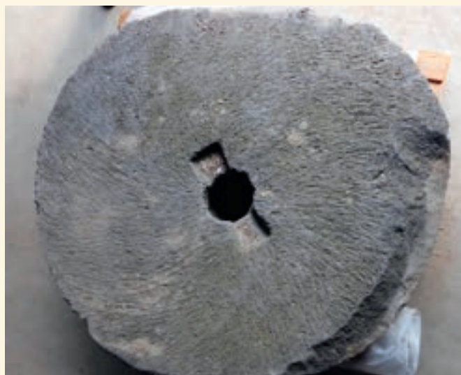
Het maalvlak van de molensteen. Duidelijk zichtbaar zijn de sporen van een primitieve bewerking van het oppervlak, het relatief kleine kropgat (waardoor bovenaandrijving uitgesloten is geweest) en de twee uitsparingen voor de zwaluwstaartvormige rij (foto Peter Pouwels, 11 juli 2018).
